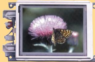
Système de fonctionnement : Pal. Principe de fonctionnement : TFT à matrice active. Dimension de l'affichage : 10 cm (4"). Nombre de pixels : 112320. Résolution : 480 (l) x 234 (L). Configuration pixels : RVB Delta. Rétro-éclairage : CCFT. Signal vidéo d'entrée : 1 Vpp / 75 Ω. Tension d'alimentation : 12 VDC. Consommation : 7 watts. Dimensions : 122 (l) x 36 (P) x 84 (H) mm. Température de travail : - 5 °C à + 40 °C. Durée garantie : 10 000 heures.
