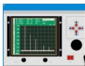
Dans les précédents numéros, nous avons largement illustré les fonctions pouvant être activées grâce aux touches présentes sur la face avant de l'analyseur de spectre. A présent, nous vous présenterons les modalités d'utilisation du générateur de TRACKING, qui permet d'afficher la courbe de n'importe quel filtre HF, de contrôler sa largeur de bande et de connaître l'atténuation du signal en dB.
