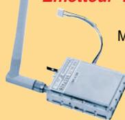
Module émetteur audio/vidéo offrant la possibilité (à l'aide d'un cavalier) de travailler sur 4 fréquences différentes (2,400 - 2,427 - 2,457 - 2,481 GHz). Puissance de sortie 10 mW sous 50 Ω, entrée audio 2 Vpp max. Tension d'alimentation 12 Vcc. Livré avec une antenne accordée.
