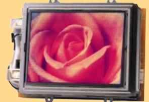
Système de fonctionnement : Pal. Principe de fonctionnement : TFT à matrice active. Dimension de l'affichage : 10 cm (4"). Nombre de pixels : 89622. Résolution : 383 (l) x 234 (L). Configuration pixels : RVB Delta. Rétro-éclairage : CCFT. Signal vidéo d'entrée : 1 Vpp / 75 Ω. Tension d'alimentation : 12 VDC. Consommation : 7 watts. Dimensions : 122 (l) x 36 (P) x 84 (H) mm. Température de travail : - 5 °C à + 40 °C. Durée garantie : 10 000 heures.
