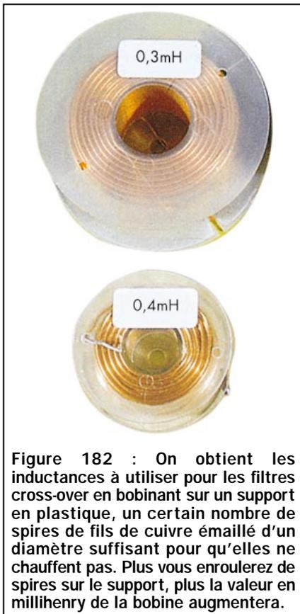
Figure 182 : On obtient les inductances à utiliser pour les filtres cross-over en bobinant sur un support en plastique, un certain nombre de spires de fils de cuivre émaillé d'un diamètre suffisant pour qu'elles ne chauffent pas. Plus vous enroulez de spires sur le support, plus la valeur en millihenry de la bobine augmentera.
