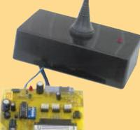
Ce kit va vous permettre de piloter de votre PC, 32 récepteurs différents. Vous pouvez utiliser tous les récepteurs utilisant les circuits intégrés type MM53200 ou UM86409. Pour radiocommande. Très bonne portée. Le nouveau module AUREL permet, en champ libre, une portée entre 2 et 5 km. Le système utilise un circuit intégré codeur MM53200 (UM86409). Décrit dans ELECTRONIQUE n° 4.
