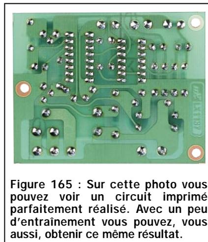
Figure 165 : Sur cette photo vous pouvez voir un circuit imprimé parfaitement réalisé. Avec un peu d'entraînement vous pouvez, vous aussi, obtenir ce même résultat.
