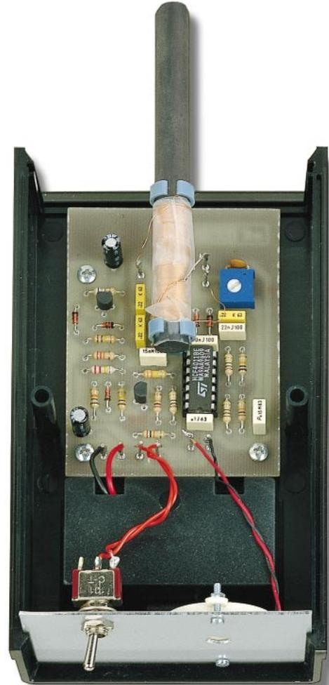
Figure 5 : Le circuit est fixé dans le coffret en plastique à l'aide de trois vis. Dans la partie vide en bas du coffret sera logée la pile 9 volts.
