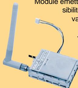
Module émetteur audio/vidéo offrant la possibilité (à l'aide d'un cavalier) de travailler sur 4 fréquences différentes (2,400 - 2,427 - 2,457 - 2,481 GHz). Puissance de sortie 10 mW sous 50 Ω, entrée audio 2 Vpp max. Tension d'alimentation 12 Vcc. Livré avec une antenne accordée.
