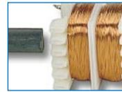
Si vous construisez des transformateurs d'alimentation, des bobinages pour des moteurs électriques ou bien des bobines pour des filtres d'enceintes acoustiques, vous savez qu'il peut arriver que la machine à bobiner écorche le vernis isolant du fil de cuivre. Si quelques spires sont en court-circuit vous ne pourrez jamais vous en apercevoir. Alors, pour déceler ces éventuels défauts, il ne vous reste plus qu'à construire cet appareil.
