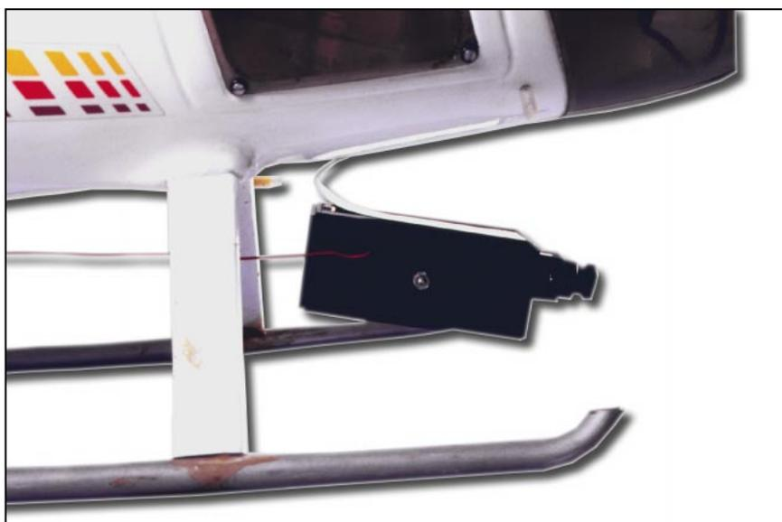
Avec l'émetteur vidéo de puissance décrit dans ces pages, nous avons effectué des prises de vues aériennes en installant une caméra et l'émetteur sous le fuselage d'un hélicoptère radiocommandé. Fabuleux !
