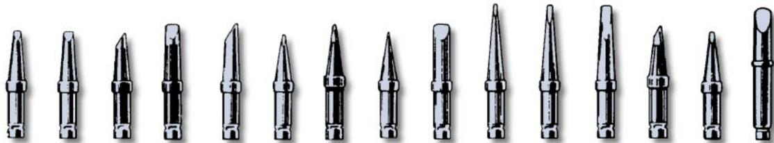
Figure 145 : Tous les fers à souder professionnels, c'est-à-dire les plus coûteux, sont dotés d'une série de pannes interchangeable de formes différentes. Les pannes fines sont utilisées pour souder les broches très rapprochées, les pannes moyennes pour des soudures normales et les plus larges, pour souder des surfaces importantes.
