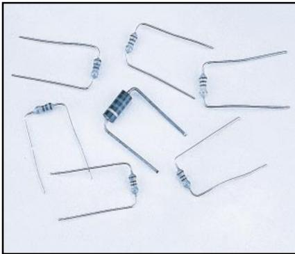
**Figure 142 : Avant d'insérer toutes les résistances et les diodes dans les trous présents sur le circuit imprimé, nous vous conseillons de plier les broches des composants, tout en gardant leur corps au centre.**
