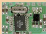
**Scrambler** Pour rendre incompréhensible n'importe quelle communication via radio ou téléphone. Idéal pour la CB, VHF et le téléphone. Le circuit est basé sur le principe de l'inversion de bande et utilise l'intégré FX118DX. Le module fonctionne en full duplex et il est réalisé complètement en CMS. Sa dimension est à peine de 2.5 x 3 cm. Les connexions sont au pas de 2,54 mm.
