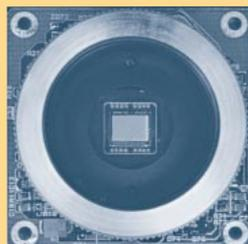
Mêmes caractéristiques électriques que le modèle standard mais avec des dimensions de 38 x 38 mm. Le module dispose d'une fixation standard pour des objectifs de type C (l'objectif n'est pas compris dans le prix).
