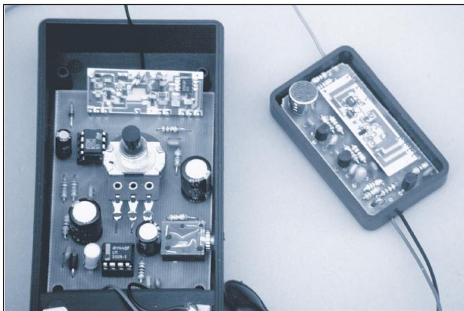
**Simple et puissant, ce micro-émetteur UHF est capable de capter les sons les plus faibles pour les transmettre par radio à une distance maximum de 300 mètres. Le circuit utilise des modules AUREL HF à 433,92 MHz réalisés en technologie CMS. Le système inclut également un récepteur portable économique.**
