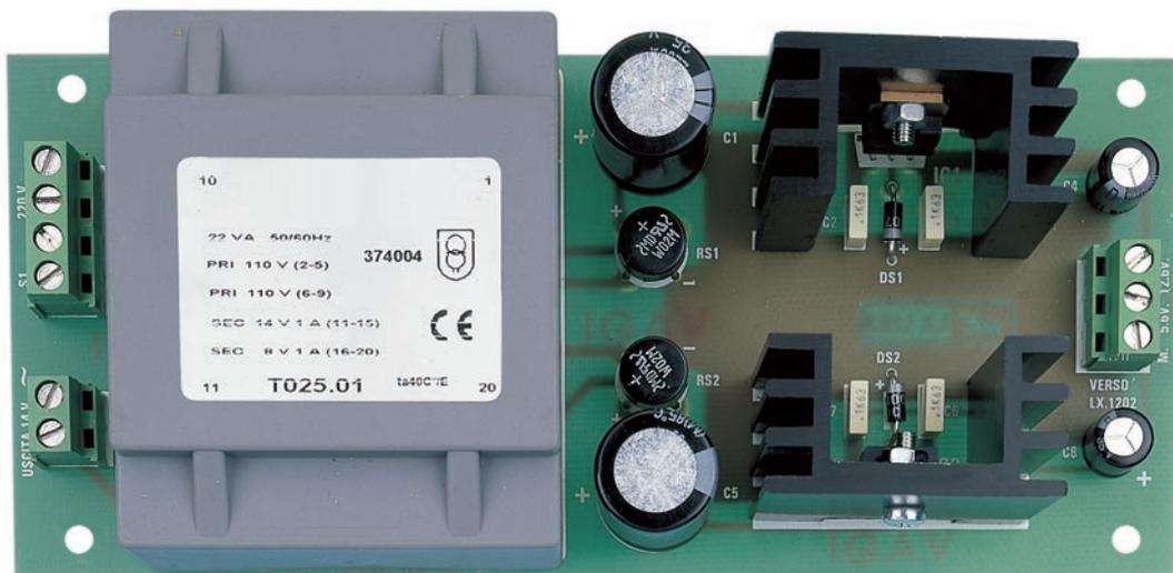
Figure 14 : Photo d'un des prototypes de la platine d'alimentation EN1203. À droite, les deux circuits intégrés régulateurs sont fixés sur des dissipateurs ML33 à l'aide de boulons 3MA. Comme le montre la figure 15, l'alimentation sera installée dans un boîtier plastique, ne serait-ce que pour éviter d'encourir le péril d'électrocution, en effet les pistes en amont de T1 sont soumises à la tension du secteur 230 V.
