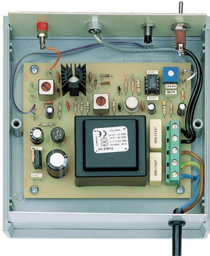
Figure 10: Photo du TX pour OM fixé à l'intérieur du boîtier plastique et vu de l'arrière. On voit à gauche de la face avant la douille de sortie où l'on connectera une antenne filaire de deux mètres, si possible maintenue en position verticale.
