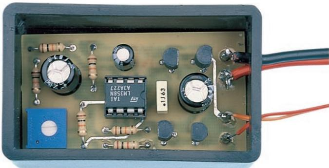
Figure 8 : Montage dans le boîtier plastique de la platine du clignotant à LED. Vous n'avez que quatre trous à faire sur le côté pour laisser passer les fils d'alimentation et de sortie vers les LED.
