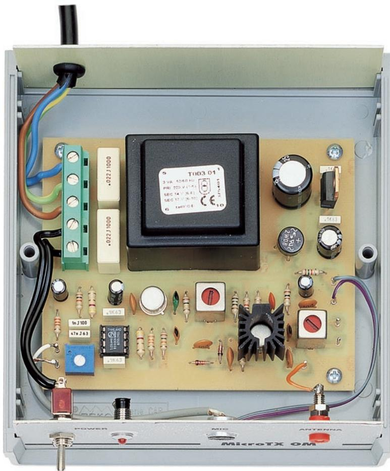
**Figure 7 :** Le circuit imprimé est fixé à l'intérieur du boîtier plastique au moyen de quatre vis autotaraudeuses. La capsule microphonique est maintenue fixée sur la face avant à l'aide de deux gouttes de colle. Avant de fermer le boîtier vous devez régler les noyaux des selfs MF1 et MF2 et le curseur du trimmer R3.
