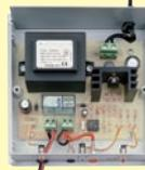
Lorsqu'une coupure de courant se produit, il est fort utile de pouvoir compter sur un système d'intervention automatique allumant une lampe ou faisant retentir une sonnerie : c'est la fonction que ce kit vous propose de réaliser.
