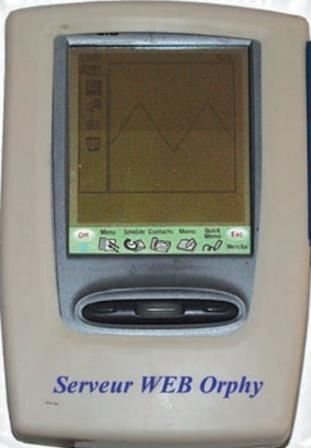
L'Orphy WEB est un serveur WEB miniature autonome qui relie au réseau TCP/IP tout instrument de mesure ou automate équipé d'un port série.
