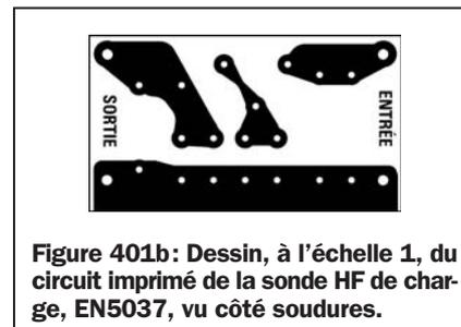
**Figure 401b :** Dessin, à l'échelle 1, du circuit imprimé de la sonde HF de charge, EN5037, vu côté soudures.
