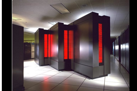
FIGURE 3.23 – La Thinking Machine contenait 65536 processeurs répartis dans un hypercube, à savoir les processeurs étaient à la « même distance » les uns des autres, par le biais d'un réseau de routage inter-processeurs. Elle pouvait toutefois être utilisée en mode asynchrone pour simuler des cas réels tels que les grands réseaux électriques.
