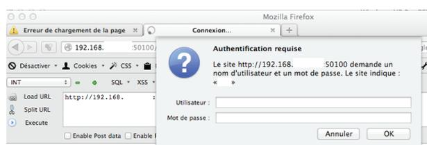
Ainsi, en contournant l'authentification, il était possible d'appeler des fonctions permettant d'exécuter des commandes sur les serveurs SAP (voir capture suivante). Et comme le compte de service utilisé par SAP possède très souvent des droits élevés sur le système, l'attaquant peut alors créer un utilisateur et prendre le contrôle du serveur sous-jacent (si un éventuel filtrage réseau permet d'atteindre les ports 445 ou 3389).
