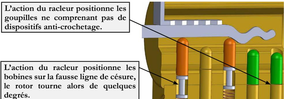
Une fois que vous avez procédé au raclage de votre serrure et décelé, par une très légère rotation du rotor, la mise en place d'une goupille anti-crochetage sur un faux cran, il vous faut alors utiliser un outil de type palpeur pour positionner cette goupille.
