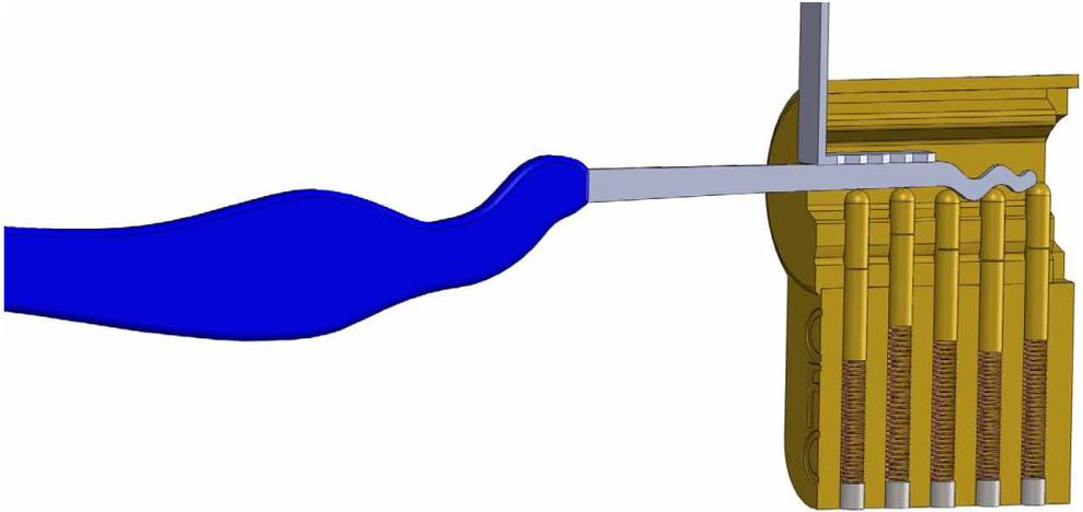
Contrairement au crochitage goupille par goupille, l'action de l'entraîneur doit ici être relativement souple car le rôle de l'outil de raclage est de pouvoir actionner plusieurs goupilles de manière simultanée.
