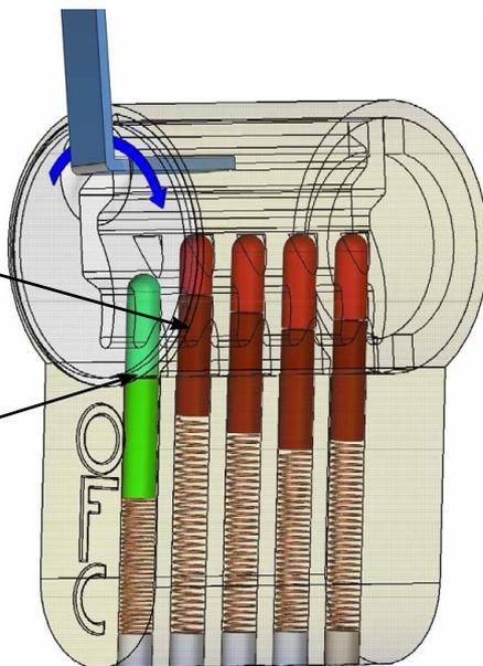
La tension appliquée sur le rotor à l'aide de l'entraîneur constitue un élément primordial pour l'ouverture fine, d'autant plus qu'il ne suffit pas d'appliquer une simple force mécanique, puisque celle-ci doit faire l'objet d'un soigneux dosage et être constamment modulée en fonction du ressenti de l'opérateur.
