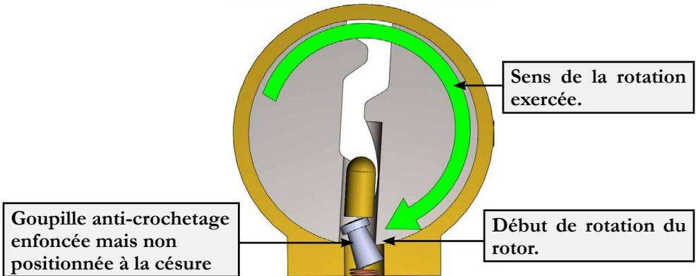
Comme on peut le constater, lorsqu'on enfonce une de ces goupilles anti-crochetage le rotor tourne légèrement, laissant supposer que cette goupille a été placée sur sa ligne de césure.
