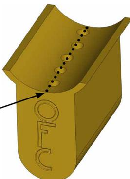
Comme les puits ne sont jamais parfaitement alignés, **lorsque l'on exerce une tension sur le rotor, sa rotation dans le stator se trouve alors bloquée par une seule goupille** et non par l'intégralité des goupilles du rotor.
