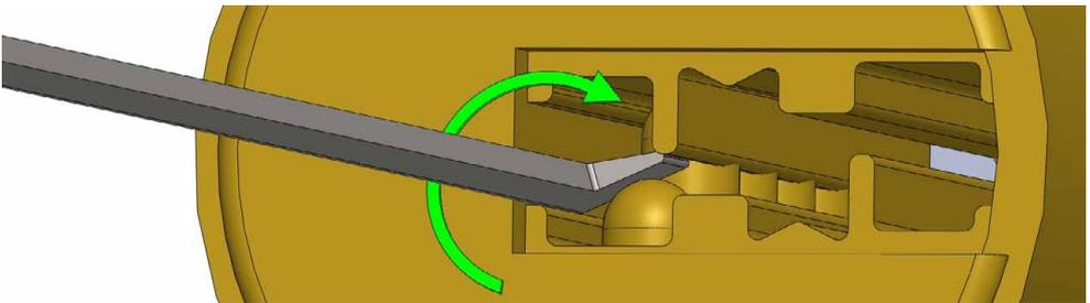
Dans certains cas, un palpeur très peu courbé, destiné aux cylindres paracentriques, viendra compléter le crochetage de la serrure radiale, principalement sur quelques modèles européens assez répandus, sur lesquels la dernière goupille doit être placée par une pression relativement forte, plus facile à appliquer en allant du bas vers le haut qu'avec un mouvement de rotation.
