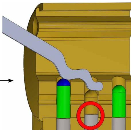
Gardez bien à l'esprit que la technique de raclage permet en général d'épuiser assez rapidement les combinaisons potentiellement formées par l'outil.
