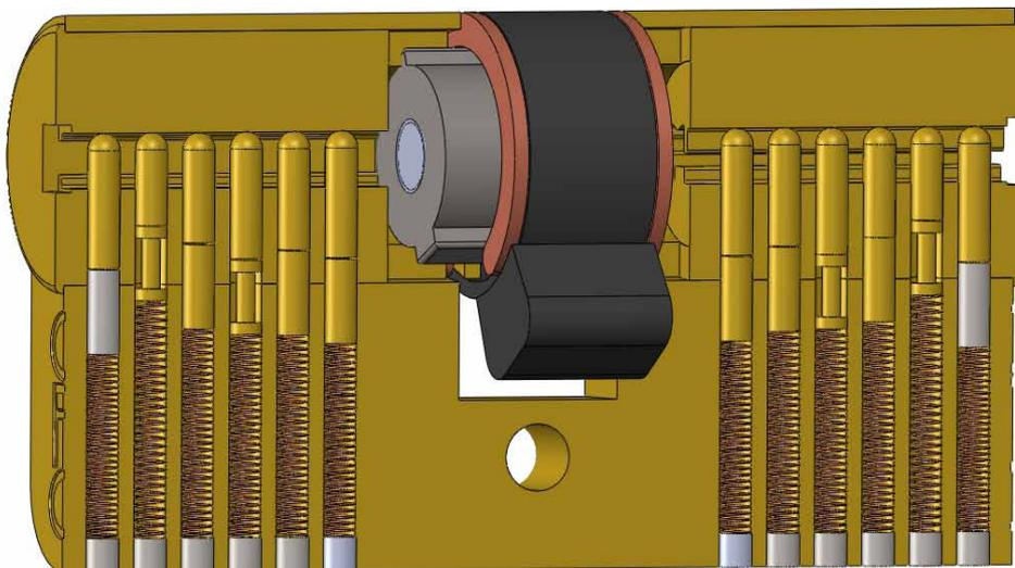
Comme on le voit sur le schéma ci-dessus, un cylindre radial a un fonctionnement identique à celui d'un cylindre paracentrique classique, il est sensible aux mêmes techniques de crochetage et nécessite également l'emploi d'un palpeur et d'un entraîneur
