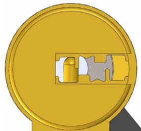
Même si la forme de clés adaptées à ces cylindres est différente des clés plates (on parle pour les serrures radiales de «clés à trous» ou «clés à points»), leur fonctionnement est rigoureusement identique.
