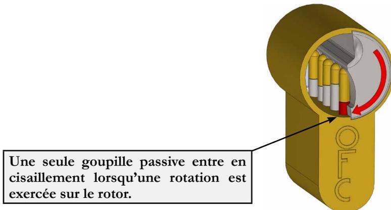
De ce fait, lors du crochetage de la serrure, lorsque la tension nécessaire est appliquée sur le rotor (à l'aide d'un outil adapté appelé entraîneur), celui-ci n'entre en friction qu'avec une seule goupille à la fois, qui se retrouve coincée entre rotor et stator.
