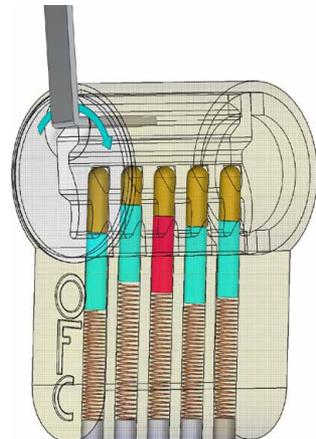
La tension appliquée doit donc être légère, mais doit obligatoirement mettre en friction rotor et goupilles.
