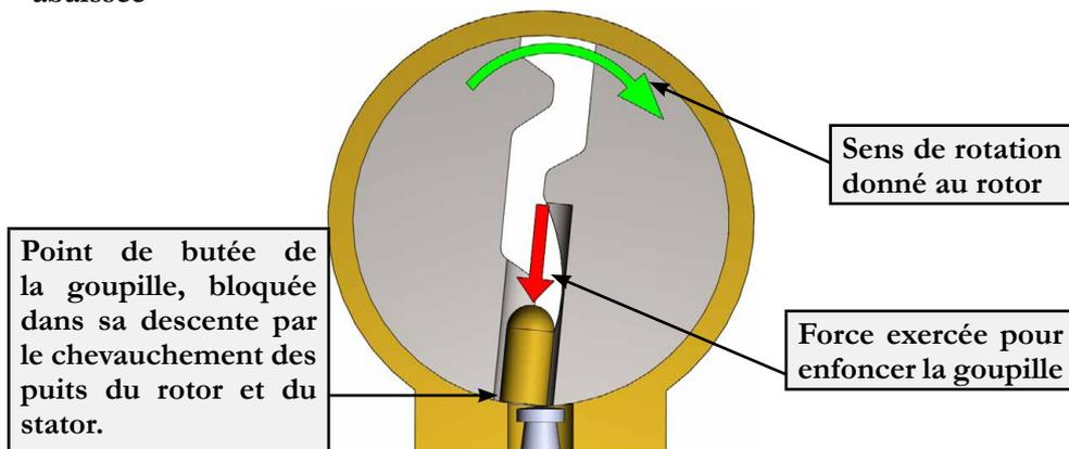
Les goupilles anti-crochetage sont donc, en général, assez faciles à contourner à condition de porter une attention particulière à la tension exercée sur le rotor par le biais de votre entraîneur.
