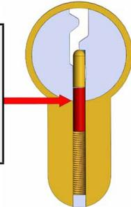
Lorsque la bonne clé est insérée, la césure active-passive est alors alignée avec la césure rotor-stator et le rotor se trouve ainsi libre de tourner.
