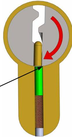
Une fois la première goupille en friction placée à la césure, il n'existe plus, à ce niveau, d'obstacle entre le rotor et le stator.
