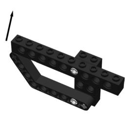
Fig. 14-6. Single-link gripper.
