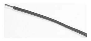
Fig. 5-9. Stripped wire.
