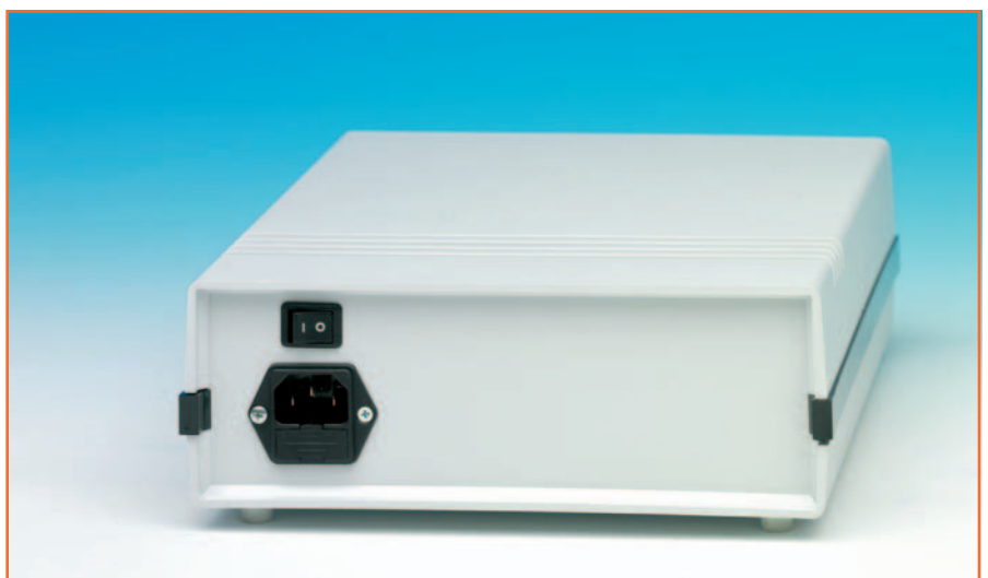
Figure 16 : Le boîtier est en plastique avec face avant et panneau arrière en aluminium anodisé. Le panneau arrière reçoit la prise secteur 230 V et l'interrupteur de M/A.
