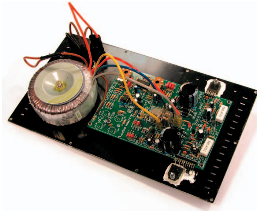
Figure 4: Photo d'un des prototypes de la platine ampli du caisson de graves bass-reflex actif.
