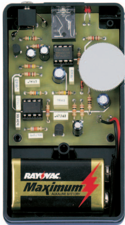
Figure 4: A droite, schéma d'implantation des composants du cardiophone (ou stéthoscope électronique) et à gauche photo d'un des prototypes de la platine installée dans son boîtier plastique. A l'extérieur du boîtier on aura le transducteur piézoélectrique (voir ENTREE CAPTEUR) et le casque à écouteurs (voir SORTIE CASQUE). La grosse roulette est le bouton de commande du potentiomètre de volume. La pile de 9 V 6F22 prend place dans son logement au bas du boîtier.
