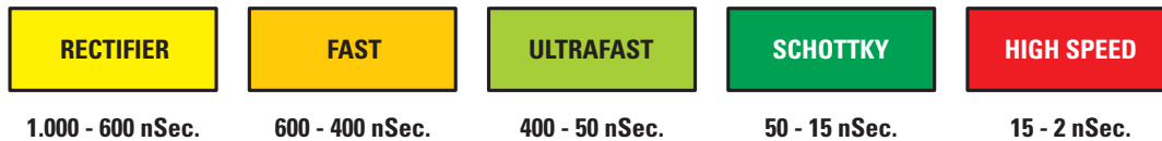
Figure 1: Les diodes les moins rapides sont celles dont la vitesse est comprise entre 1 000 et 600 nanosecondes; elles sont utilisées pour redresser la tension du secteur à 50 Hz. Les plus rapides sont les High Speed qui peuvent atteindre 12 à 2 nanosecondes.
