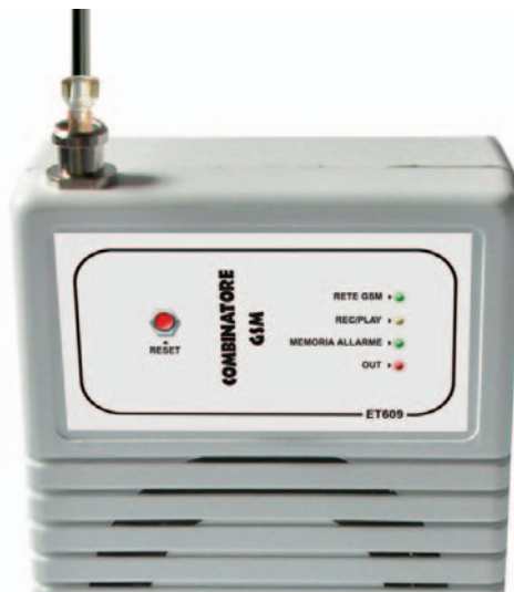
Figure 8: En face avant du boîtier spécifique se trouvent le poussoir de "reset" de la mémoire des alarmes et les quatre LED signalant l'enregistrement et la reproduction du message vocal au moment de la configuration, la survenue d'une alarme, la présence du champ GSM et l'état de la sortie collecteur ouvert.
