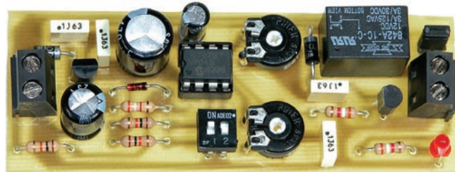
Figure 4b: Photo d'un des prototypes de la platine du système de gestion d'alimentation pour localiseur.
