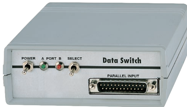
Figure 9: Le boîtier de l'interface Data switch EN1265. Le connecteur mâle à 25 broches est à relier au port parallèle de l'ordinateur. Les deux connecteurs femelles du panneau arrière sont à connecter aux deux appareils qu'on veut desservir, ici le générateur et l'imprimante.
