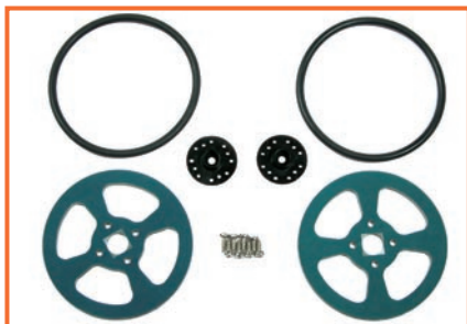
Figure 3 : L'insertion des roues. Les roues motrices aussi sont en fibre de verre. A gauche, toutes les pièces nécessaires au montage. Après avoir inséré l'anneau servant de pneu, vissez les vis autotaraudeuses dans le moyeu, en contrôlant bien le centrage, avant le serrage définitif. Même chose pour l'autre roue.
