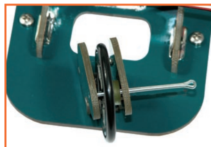
Fixez le support sur le côté inférieur de la structure en utilisant la vis, les deux rondelles et l'écrou autobloquant. Il est important de serrer juste comme il faut l'écrou pour que la fourche puisse tourner librement. Pour monter la roulette, utilisez la goupille spéciale et les deux entretoises.
