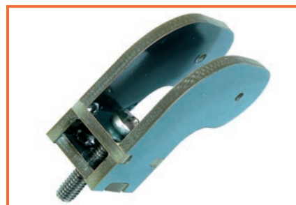
Pour monter la troisième roue, on a besoin de tous les éléments de gauche. Avec un fer à panne fine, soudez les 4 pièces en fibre de verre métallisée afin d'obtenir la fourche de roue (à droite). Insérez la vis 4MA comme sur la photo de droite.
