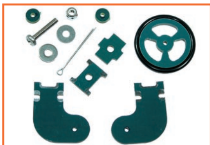
Pour monter la troisième roue, on a besoin de tous les éléments de gauche. Avec un fer à panne fine, soudez les 4 pièces en fibre de verre métallisée afin d'obtenir la fourche de roue (à droite). Insérez la vis 4MA comme sur la photo de droite.
