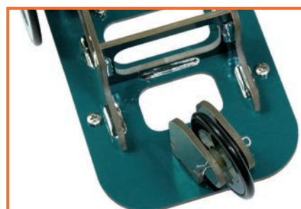
Insérez dans l'ordre la goupille (axe), la première entretoise, la roulette et la seconde entretoise. Pour insérer cette dernière, aidez-vous au besoin d'une petite pince. Avec un peu de patience vous réussirez à fixer le tout. A la fin, écartez les deux moitiés de la goupille.
