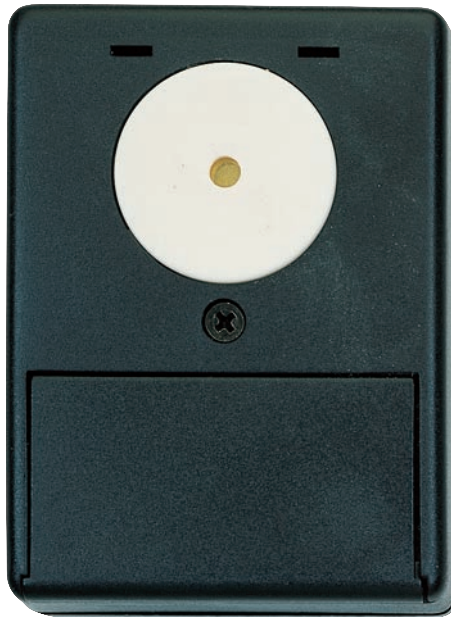
Figure 2: Sous la platine de la figure 1, on a inséré dans le grand trou le buzzer de signalisation. Grâce à la porte à tirette du bas on peut accéder à la pile. L'autre demie coque (non visible ici) comporte le trou d'affleurement de la photorésistance et le passage pour le réglage de la sensibilité.
