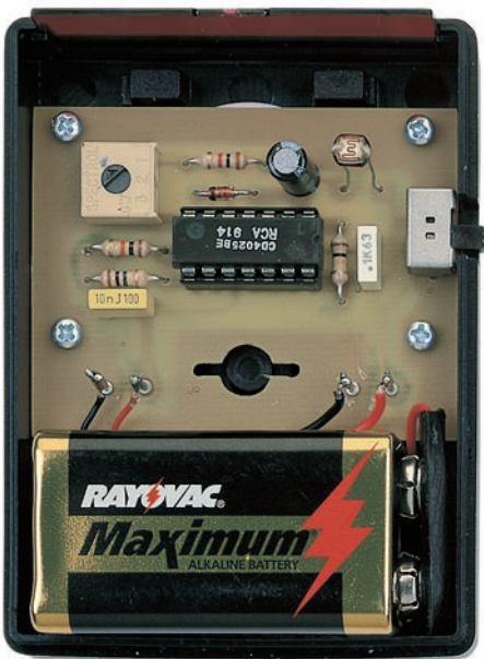
Figure 1: Photo d'un des prototypes de la platine détecteur d'exposition à la lumière déjà installée dans son boîtier plastique. La minuscule photorésistance se trouve en haut à droite. La pile 6F22 de 9 V trouve son logement dans le boîtier sous le bord inférieur du circuit imprimé. Sur le côté, l'interrupteur S1 de M/A.
