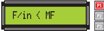
Figure 23 : Si vous paramétrez le fré- quencemètre pour soustraire une va- leur quelconque de MF et si vous n'ap- pliquez aucune fréquence à l'entrée, sur l'afficheur apparaîtra F/in < MF.
